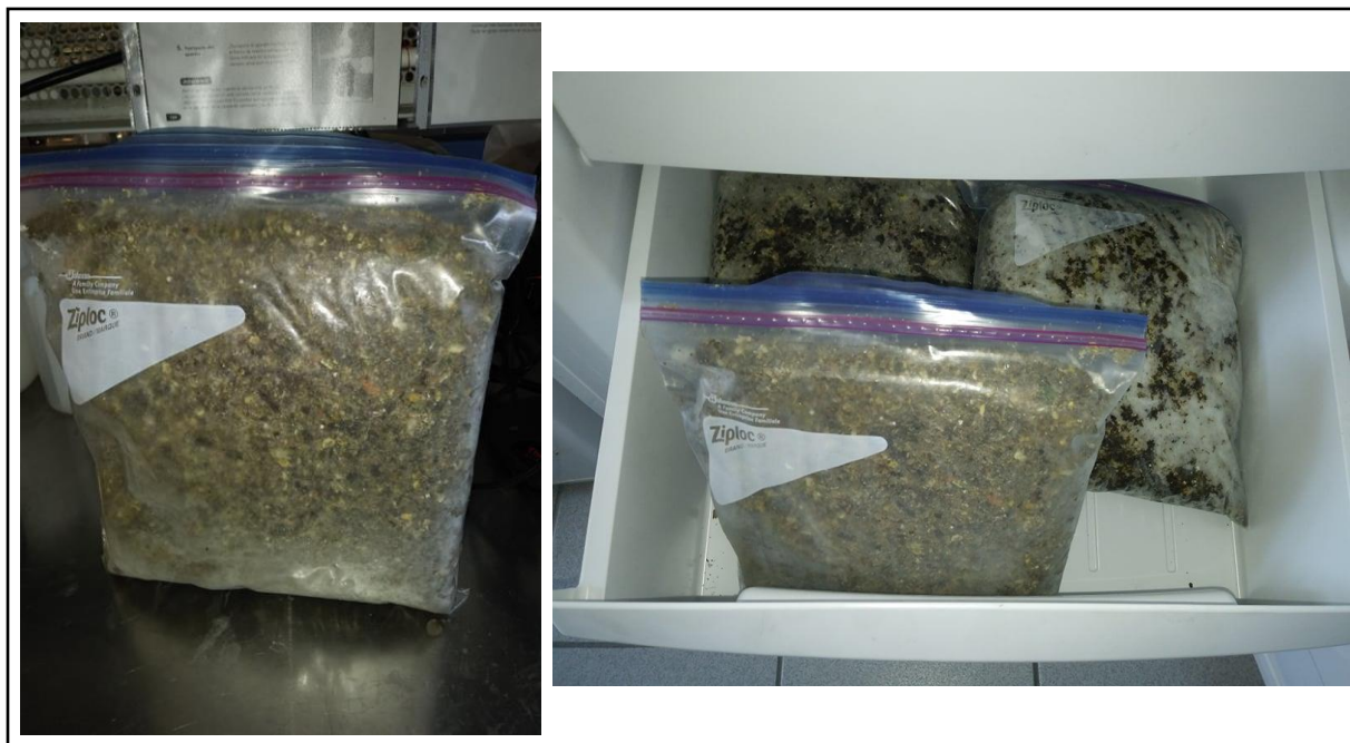
Figura 3.2. Almacenamiento de la FORSU y congelación a -20^{\circ}\text{C}
