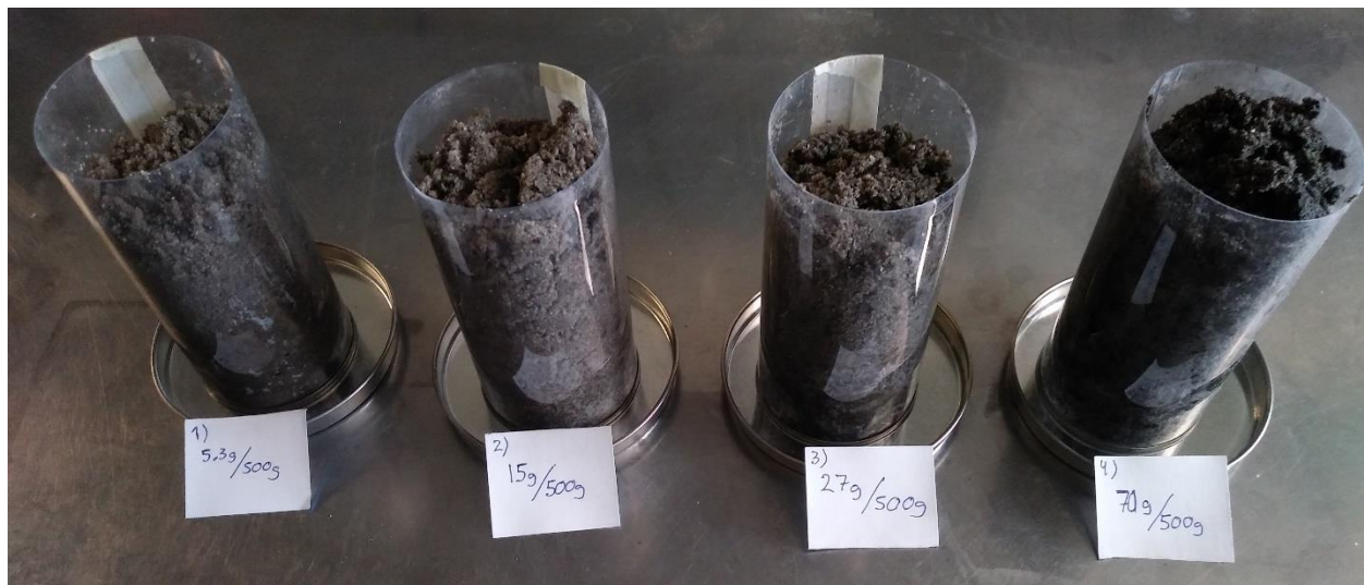
Figura 4.5. Mezclas preparadas de muestras de 500 g de arena con digestato de la FORSU (De izquierda a derecha, proporciones de 5.3, 15, 27 y 70 g)
