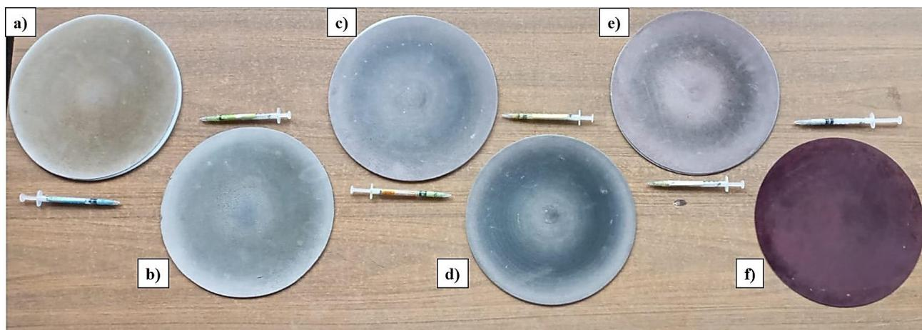
**Figura 3.6.** Paños y uso de pasta diamante (en  $\mu\text{m}$ ): a) 15, b) 9, c) 6, d) 3, e) 1 y f) 0.1, respectivamente.
