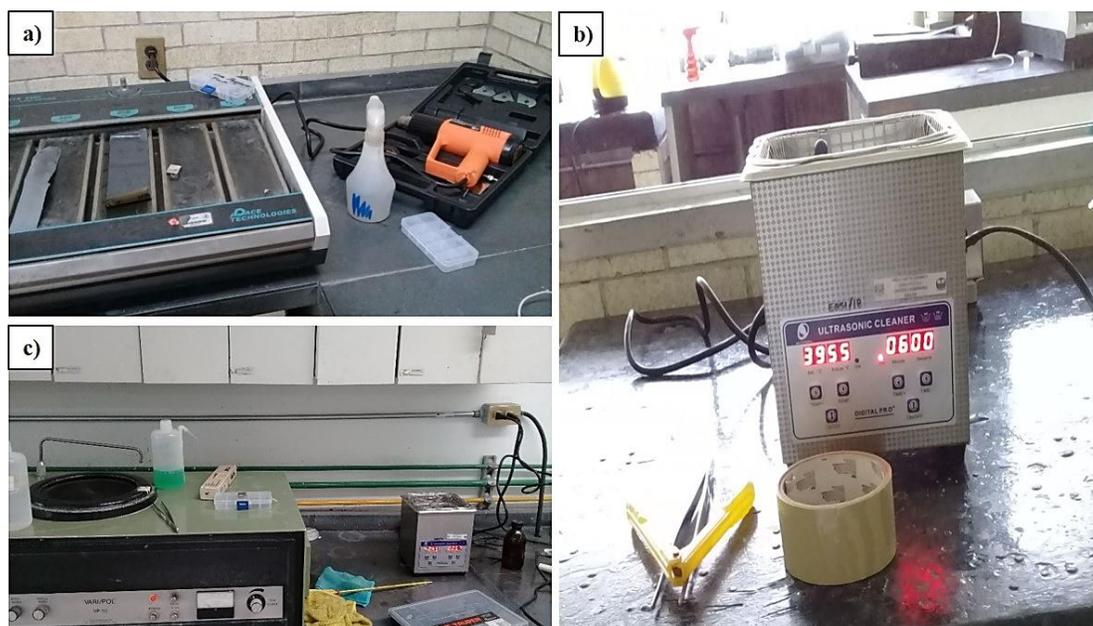
**Figura 3.5.** Equipo utilizado para la preparación metalográfica: a) Mesa de desbaste con equipo, b) Baño de limpieza ultrasónico y c) Pulidora automática con paño y pasta diamante.
