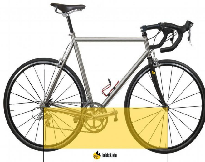
Figura A4 – Distancia entre ejes (D).
