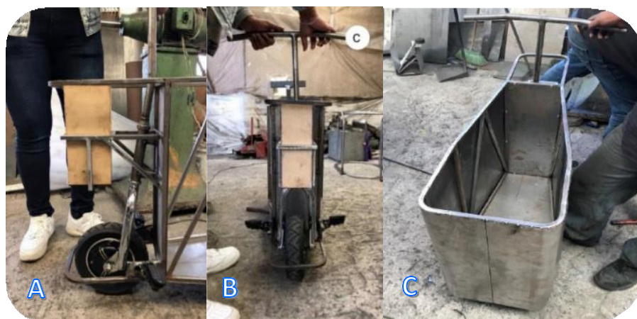
Figura 8.4 – Segunda etapa de manufactura para el prototipo del VUMi3: A), B) carcasa para el módulo de la batería, C) colocación del sistema envolvente.
