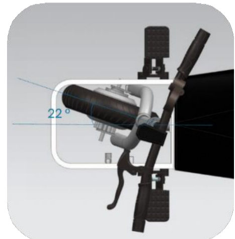
Figura 6.9 – Ángulo de dirección del VUMi3
