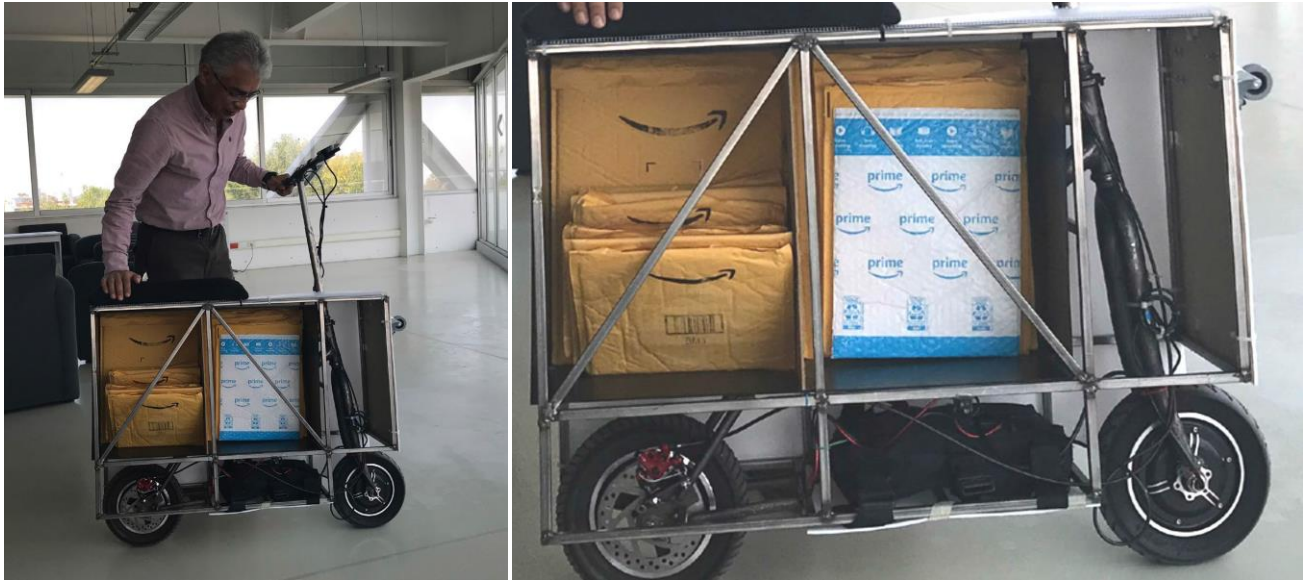
Figura 2.14 Prueba con usuarios con el prototipo VUM (izquierda). Distribución de los paquetes y componentes electrónicos (derecha).
