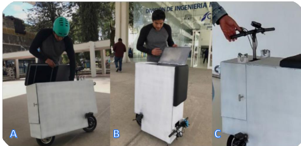
Figura 2.24 – A) Apertura de puerta principal para acceso a paquetes, B) Puerta auxiliar de acceso a paquetes, C) Puerta de acceso a componentes eléctricos electrónicos.
