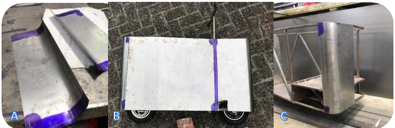
Figura 8.3 – Segunda etapa de manufactura para el prototipo del VUMi3: A) Rolado de láminas traseras, B) presentar el posicionamiento de láminas en el prototipo, C) Colocación de la lámina trasera.
