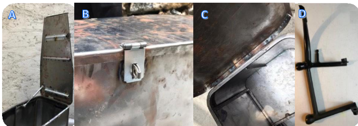
Figura 8.6 – Tercera etapa de manufactura para el prototipo del VUMi3: A) Colocación del amortiguador para la puerta de paquetería, B) Colocación del grillete para el candado, C) soldadura para la bisagra de piano en la parte posterior del vehículo, D) Manufactura del caballete.
