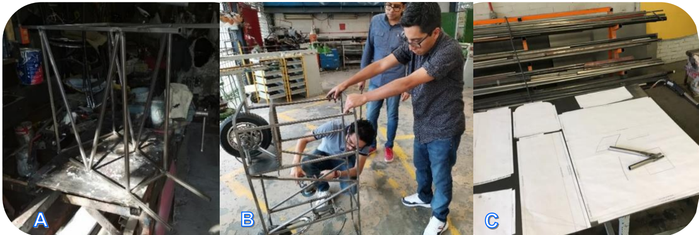
Figura 8.1 – Primera etapa de manufactura para el prototipo del VUMi3. A) Base estructural del prototipo VUMi3 en el taller particular, B) detallando la base estructural del prototipo VUMi3, C) Acomodo del sistema envolvente en hoja de lámina.
