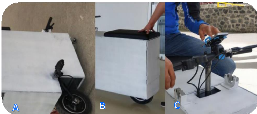
Figura 2.25 - A) Reposapiés plegables, B) Asiento forrado de tela vinil negro, C) Soporte para celular
