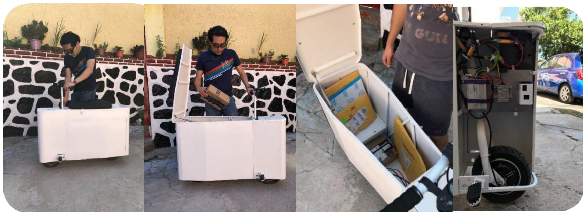
Figura 8.8 – Tercera etapa de manufactura para el prototipo del VUMi3: integración de todos los elementos en el prototipo de VUMi3.
