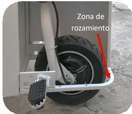
Figura 8.12 – Rozamiento de la llanta delantera y la U frontal inferior.
