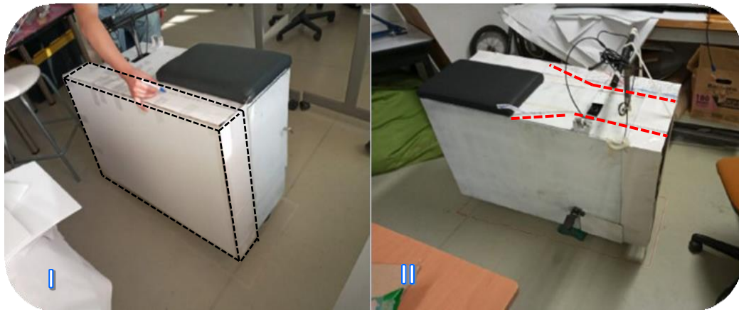
Figura 5.1 – I) Simuladores de cartón con el prototipo VUMi2, II) Geometría propuesta marcada en el simulador de cartón.
