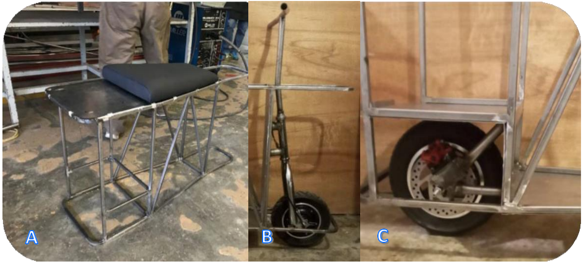
Figura 8.2 – Primera etapa de manufactura para el prototipo del VUMi3: A) Ajuste de asiento, B) Colocación de la dirección, C) implementación de la tijera trasera.
