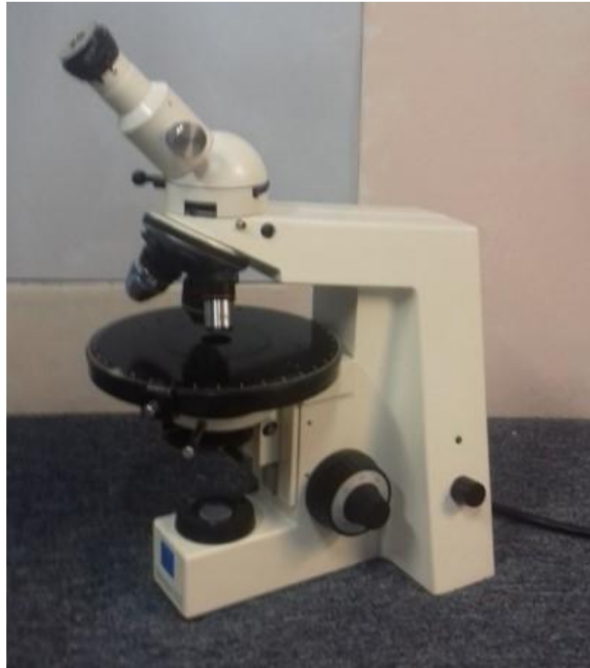
Figura 38. Microscopio petrográfico ZEISS-Primotech
