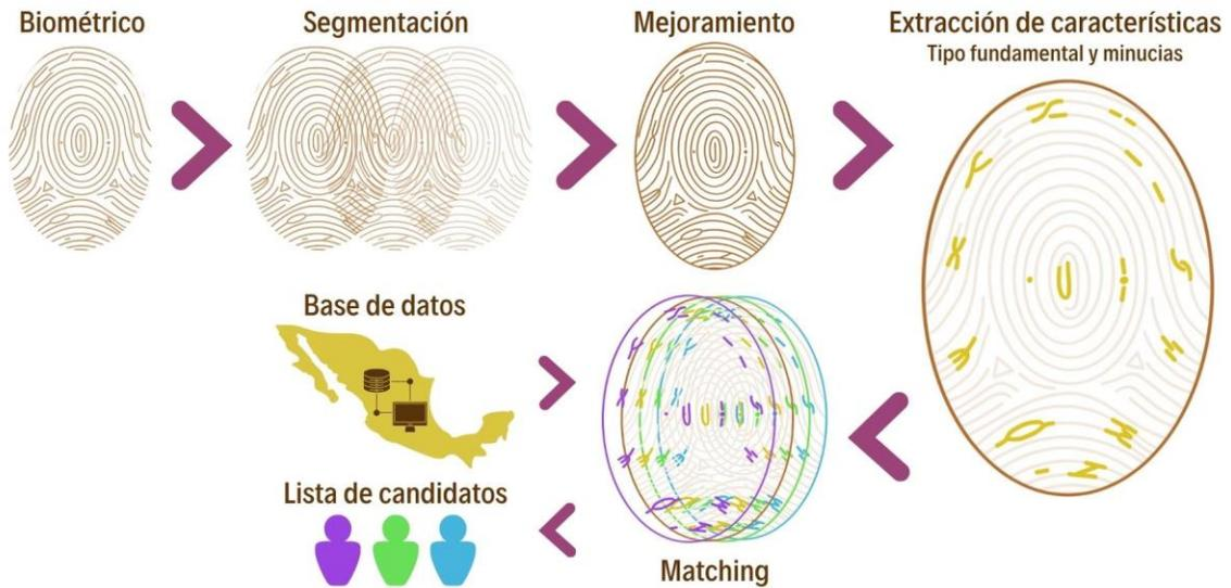
Imagen 13. Diagrama general de un sistema de reconocimiento basado en huellas dactilares.
