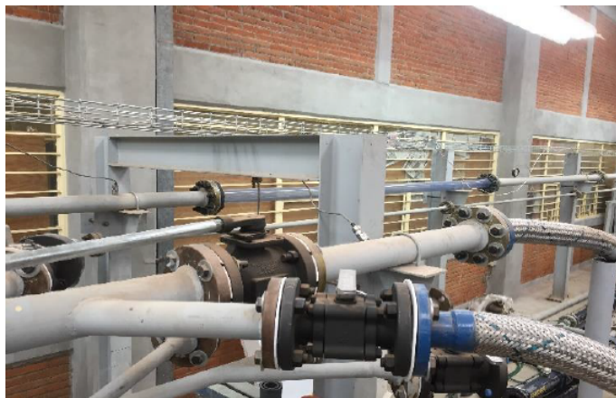
Figura 3.7: Inyector trifásico (Hernández, 2019).
