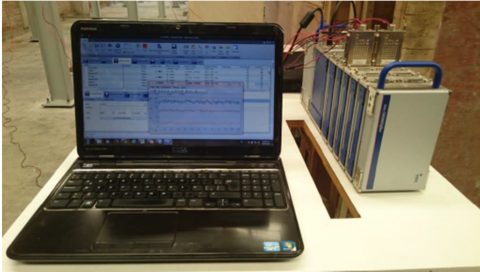
Figura 3.11: Monitoreo de presiones durante una prueba (Hernández, 2019).
