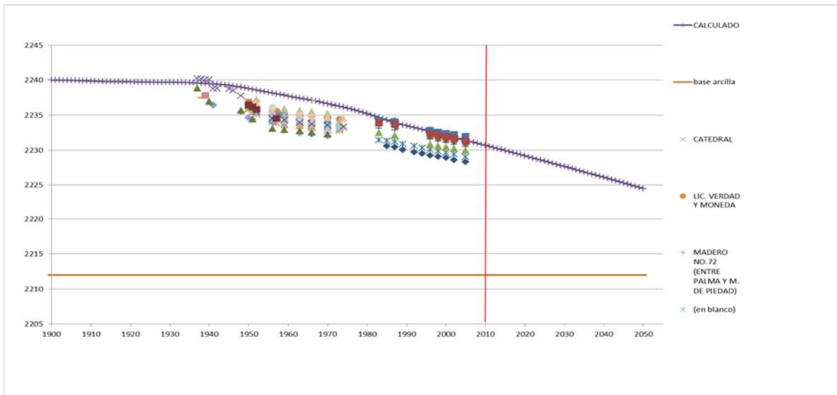
Figura 5.22 Comparación de la evolución de los hundimientos calculados y observados para el Centro de la Ciudad de México
