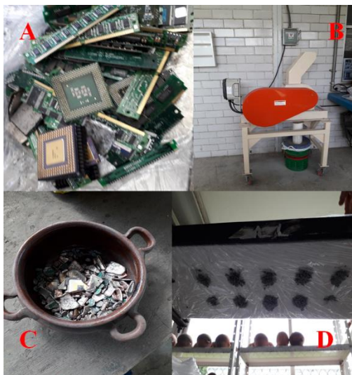
Figura 6. Acondicionamiento de los RAEE para el proceso de lixiviación
