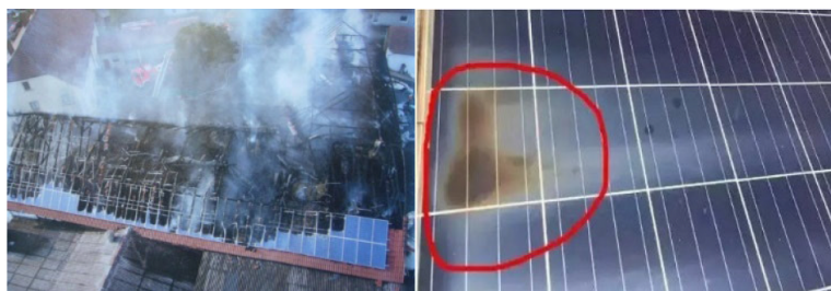
Figura 2.6: Punto Caliente en Módulo Fotovoltaico. [13]
