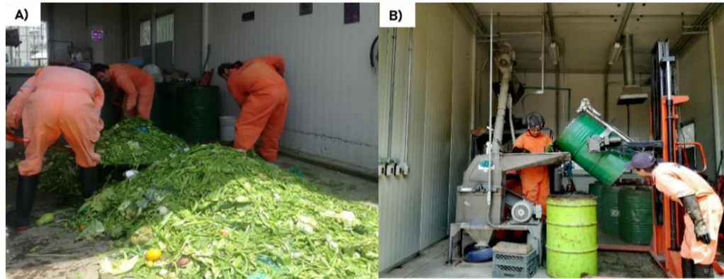
Figura 29. A) Cuarteo de la FORSU para obtención de la muestra y B) disminución del tamaño de partícula del sustrato in situ .
