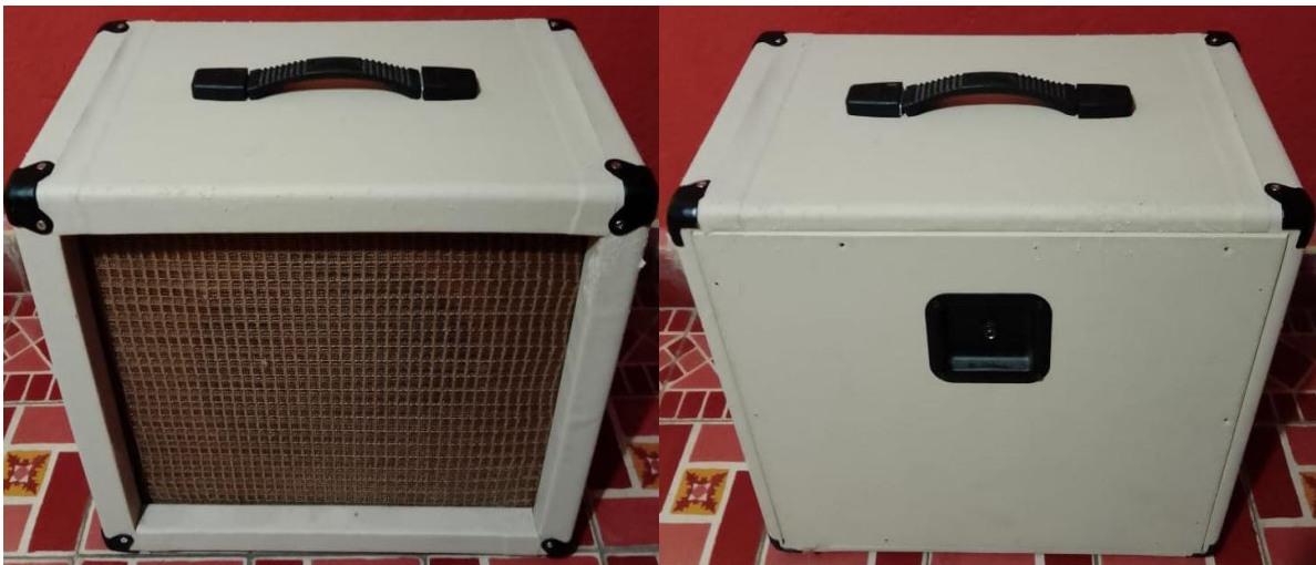
Figura 4.19 caja del amplificador con la bocina montada en ella.
