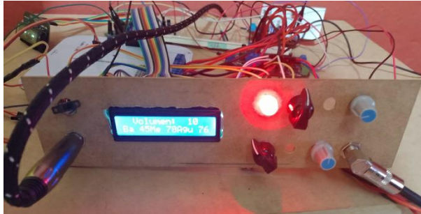
Figura 4.26 Amplificador muestra al usuario lectura de potenciómetros analógicos.
