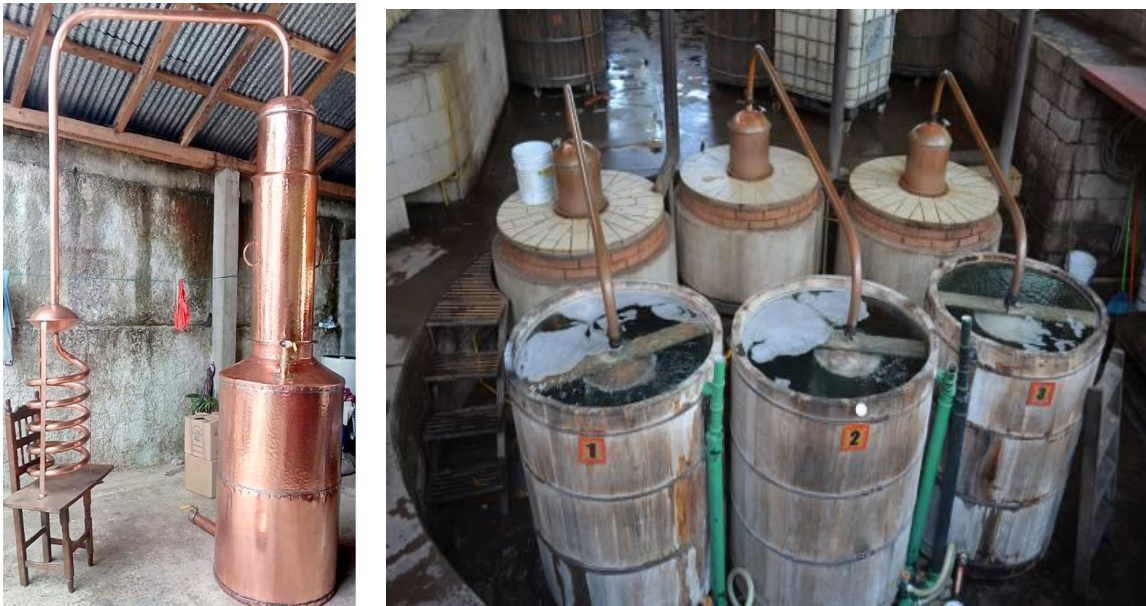
Fig 3. Alambiques artesanales de cobre y cobre-madera (destiladoresdecobre.com.mx, 2020; Coppel, 2018).
