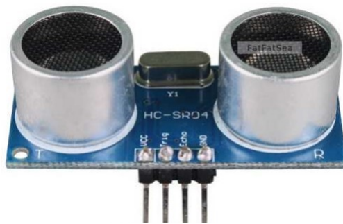
Figura 4.5: Sensor de distancia HC-SR04 (24)
