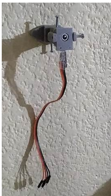
Figura 7.6: Sensor empotrado en la pared con el elemento de sujeción de tres grados de libertad (Martínez-Martínez, 2021)
