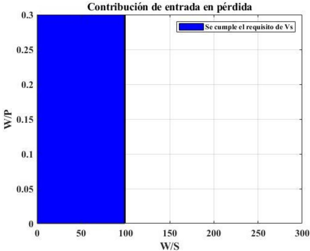
**Figura 2. 11 Aportación de velocidad de entrada en pérdida para aeronaves impulsadas por hélice**
