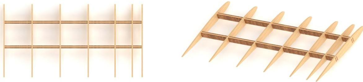
**Figura 5. 23 Estructura del estabilizador horizontal**
