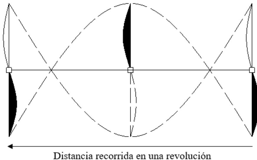
**Figura 3. 25 Paso de una hélice.**
