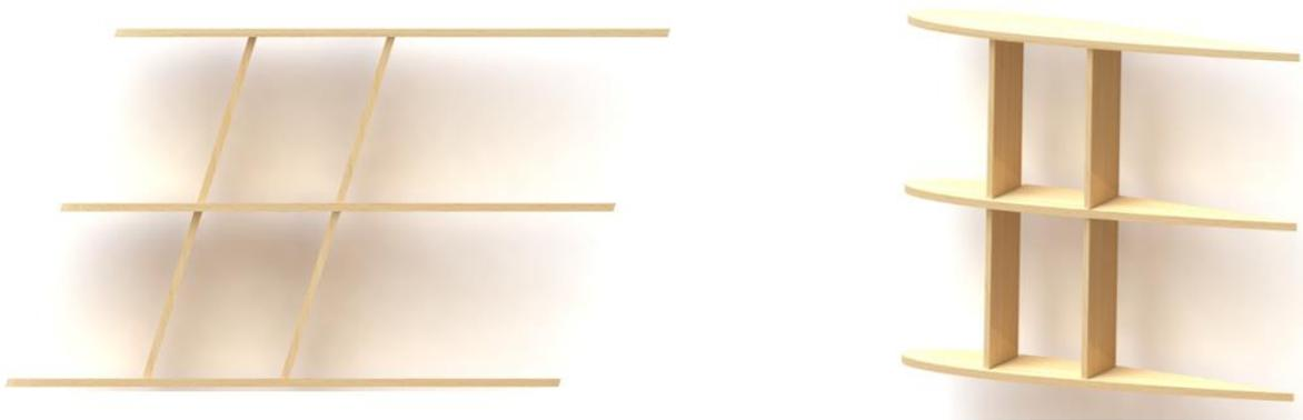
**Figura 5. 15 Estructura del estabilizador vertical**
