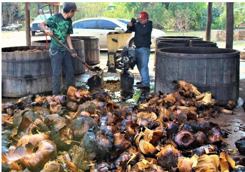
Figura 4. Molienda de tallos de *Dasyliirion* ssp. con triturador automático, (sotolera Oro de Coyame)
