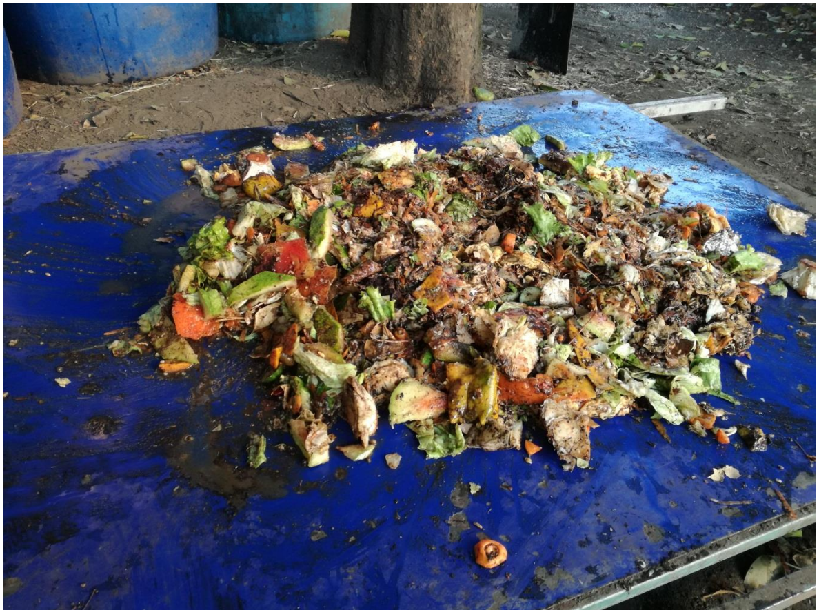
Figura. 2. Fracción orgánica de los RSU (FORSU), antes de ser procesada. Nótese la diversidad de sus componentes. Fuente: propia.
