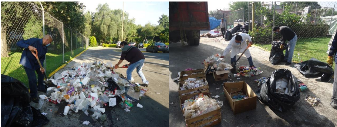
Figura 22. Método de cuarteo y cuantificación de los residuos que integran los RSU de la FESI. Fuente: PROMIR.
