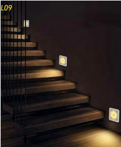
Luminaria de cortesía. Se propone un sistema de control on/off a través de un sensor de presencia en pared.
