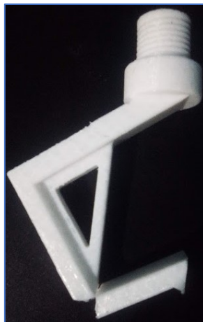
Figura 6.50 Componente mecánico en material plástico fracturado en la zona marcada por el software CAE
