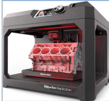
Figura 6.31 Impresora 3D tipo FMD imprimiendo bloque de cilindros para automóvil. Tomada de: https://www.bhphotovideo.com/c/product/1296081-REG/makerbot_mp07825_replicator_3d_printer.html
