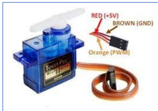
Figura 6.20 Servomotor con sus cables de conexión
