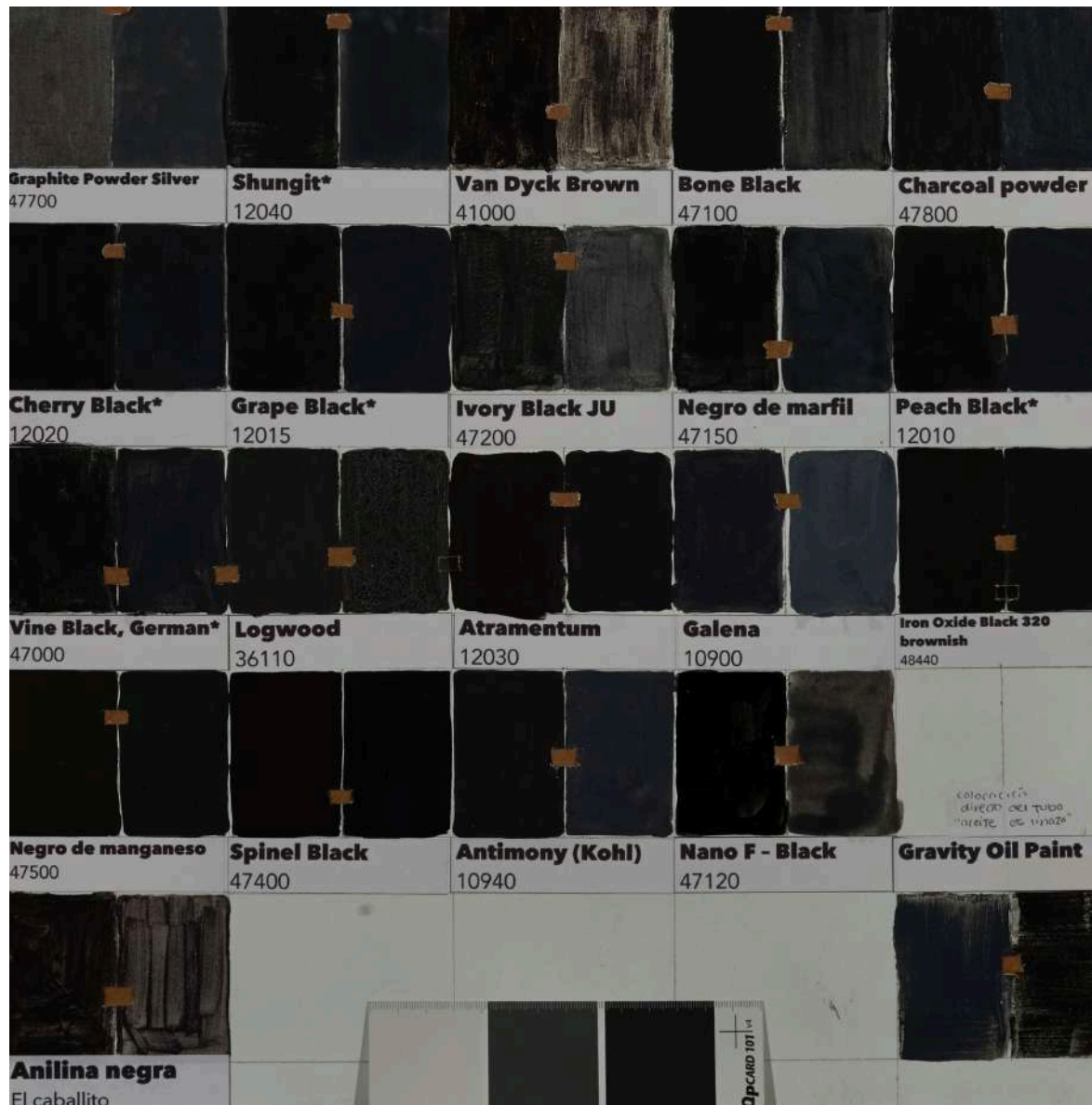
Ilustración 1 Probetas de materiales negros en espectro visible
