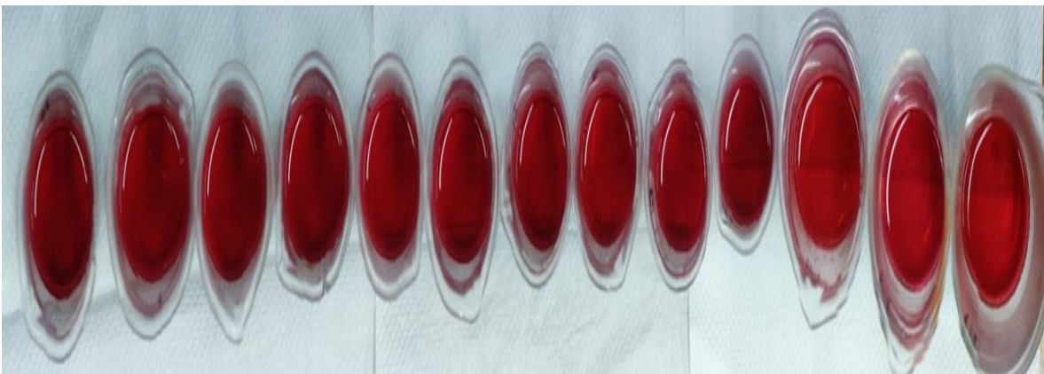
Figura 24 Cambio de coloración en el experimento de oxidación de fenol, 20 mg/L utilizando malla sin recubrir.
