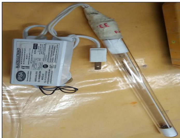
Figura 15 Lámpara UV de 15W, de tubo de vidrio de cuarzo de 304.8 mm de largo y 2cm de diámetro, con salida de espectro de 253.7nm
