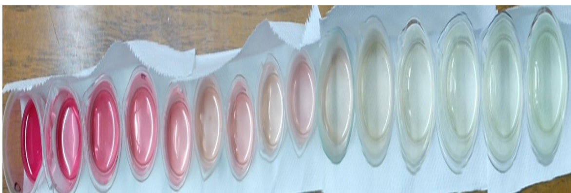
Figura 29 Cambio de coloración en el experimento de oxidación de fenol, 20 mg/L usando mecanismo de fotocátalisis.
