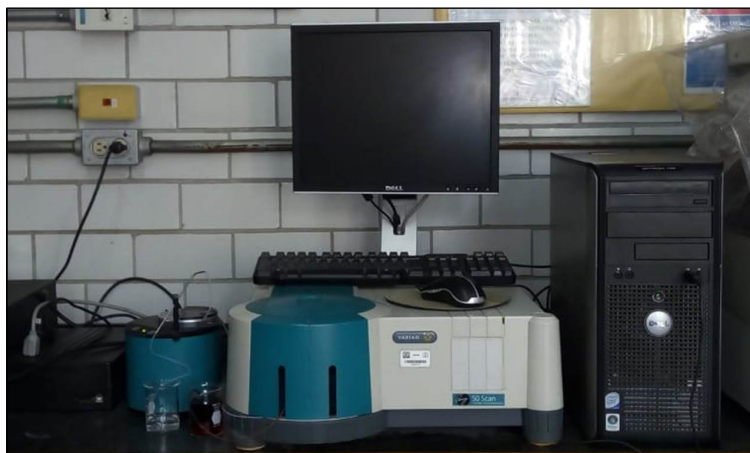
Figura 18 Espectrofotómetro ultravioleta -visible marca Varian, modelo Cary 50.
