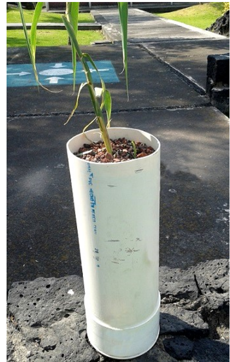
Figura 3.5. Reactor de PVC para el crecimiento de las plantas acuáticas
