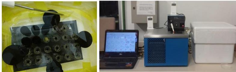
**Figura 19.** Sistema de respirometría. Cámaras respirométricas (izquierda). Software, regulador de temperatura, las cámaras respirométricas se ubican a baño maria dentro del contenedor de unicel (derecha).
