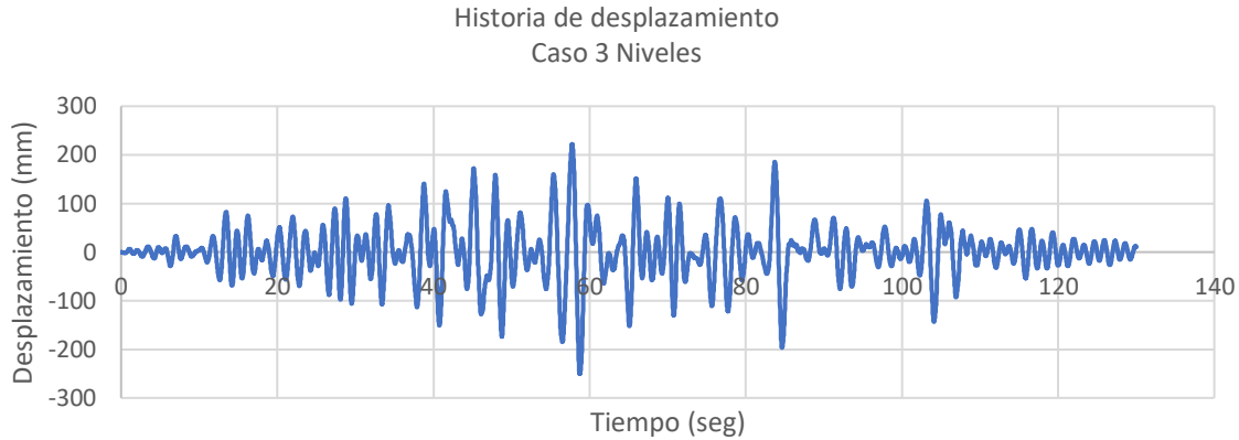
Figura 5.4 Respuesta en términos de desplazamiento en la base para el oscilador no lineal.
