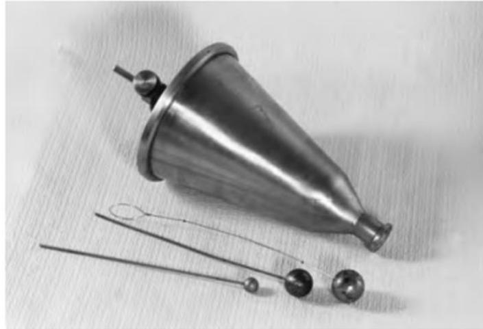
**Figura 7.3.** Viscosímetros de caída de bola y copa de flujo.
