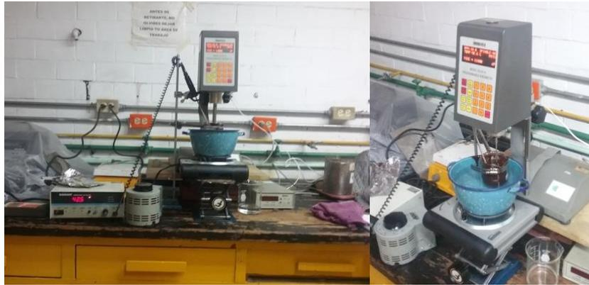
**Figura 10.15.** Equipo utilizado para la caracterización viscométrica de las mezclas
