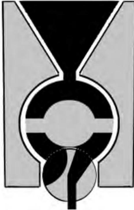
**Figura 4.47.** Esquema del mecanismo tipo pistón para dispensar una cantidad medida de chocolate en un molde específico en el proceso de moldeado del chocolate.
