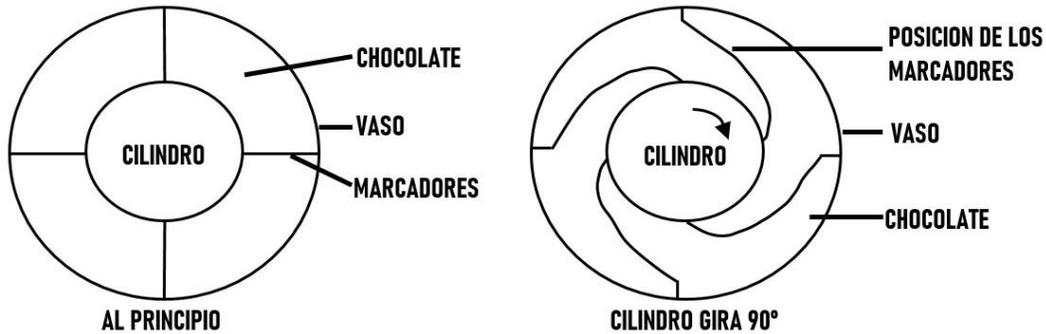
**Figura 7.5.** Flujo entre la copa y la mecha del viscosímetro de cilindro concéntrico.
