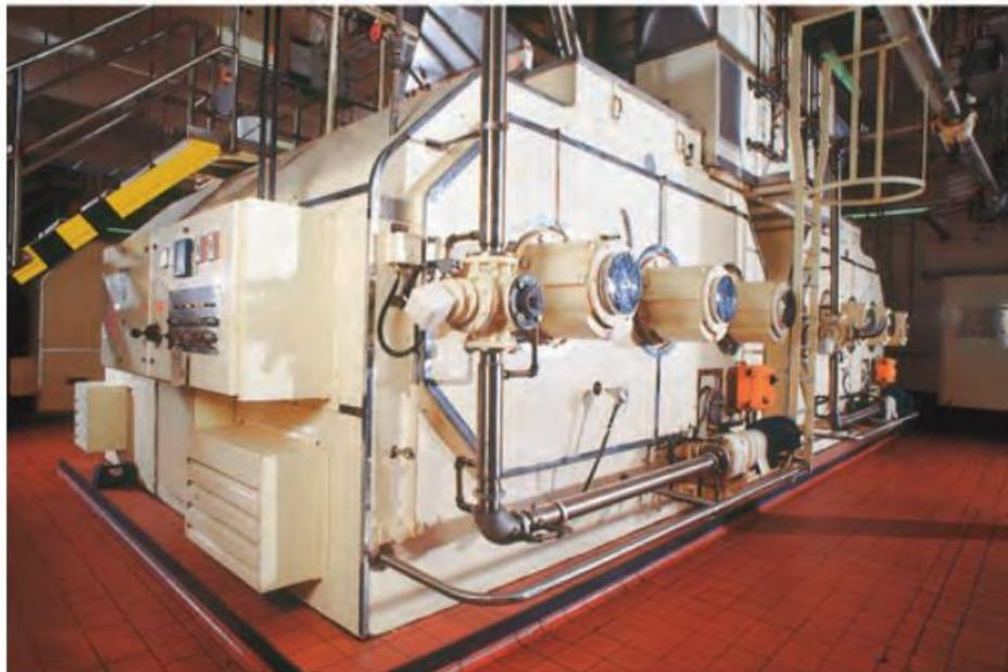
**Figura 4.39.** Imagen de una caracola fabricada por Frisse, Alemania.
