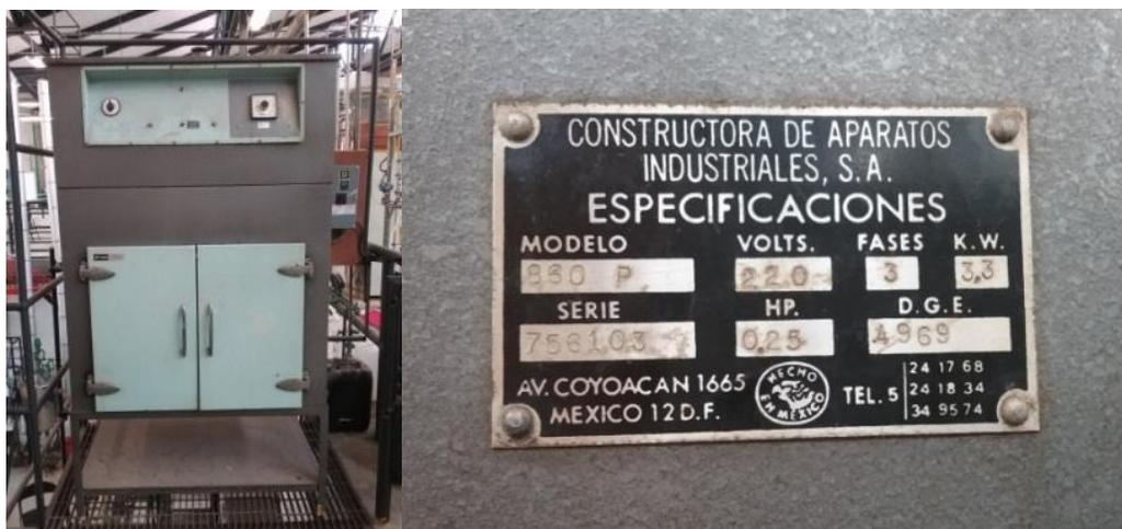
**Figura 10.1.** Horno utilizado marca CAISA Alley y sus especificaciones (No. Inventario UNAM: 2178773)
