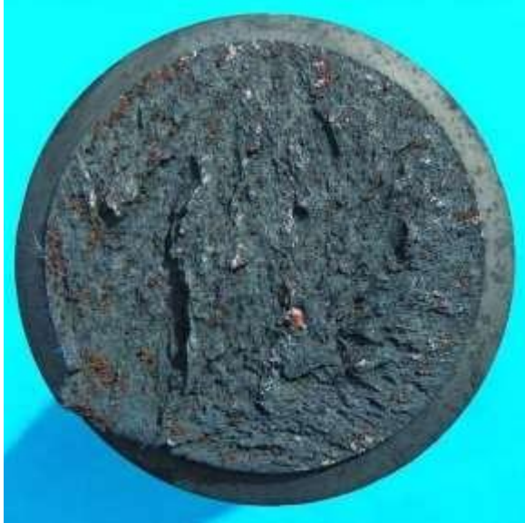
Figura 6 Falla frágil a tensión (Mora & Martínez., 2011)
