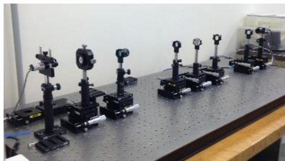
Figura 6.10 Sistema del laboratorio con los dobletes al límite de difracción.
