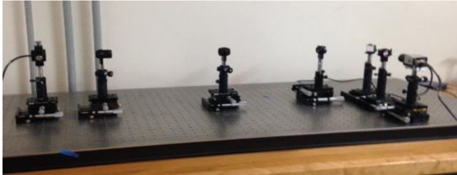
Figura 6.6 Sistema del laboratorio para la adquisición de las imágenes con dos etapas colimador-cámara.
