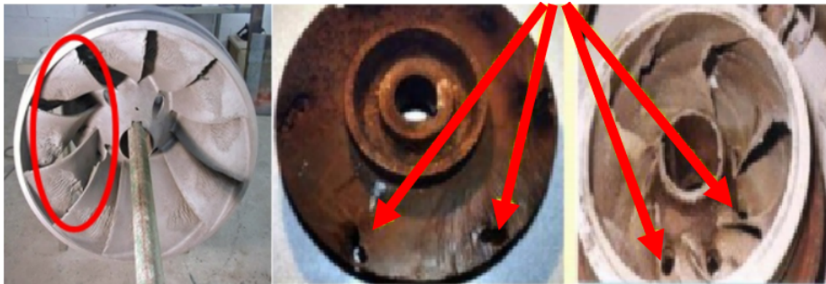
Figura 2.14: Daños causados por la cavitación [Google]
