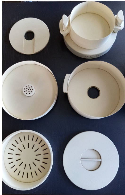
Figura 44. Prototipo de cartón cortado a láser. Elaboración propia
