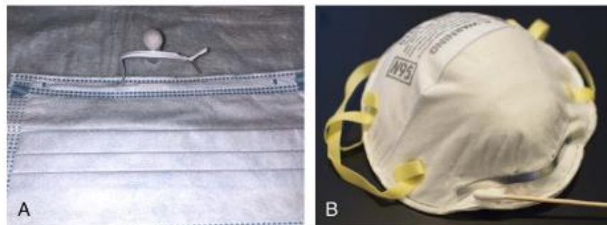
Figura 13.- A, prueba DMG positiva (coloración rosada en mascarilla quirúrgica. B, prueba DMG negativa en respirador N95. DMG dimetilglioxima ocupacional.
