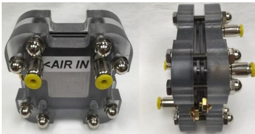
Figura 6. Celda electroquímica comercial Flex-Stak [11].
