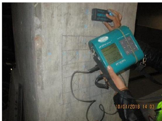
**Figura 59. Escaneo de acero de refuerzo (adaptada de Fernandez, 2020)**
