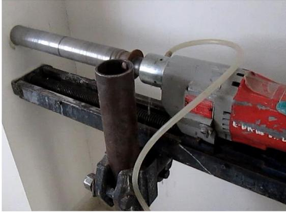
a) Extracción de núcleo de concreto en columna
