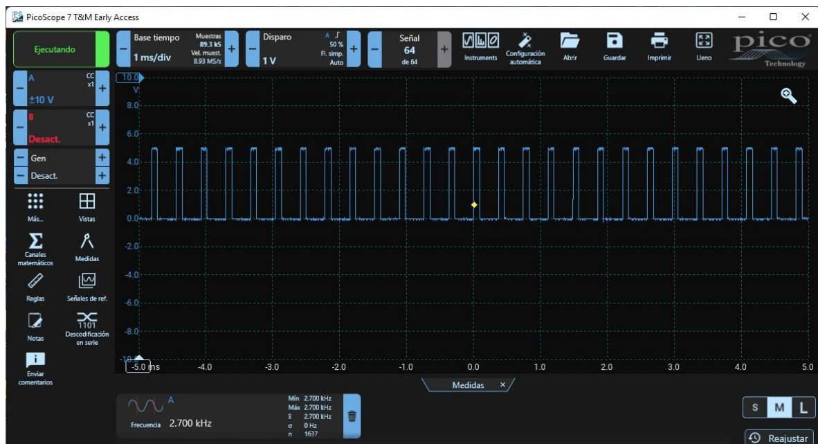
Figura 20: Medición de frecuencia con osciloscopio.
