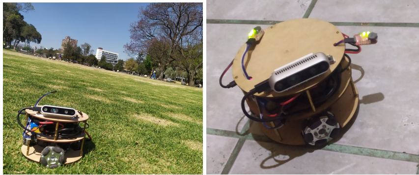
Figura 4.15: Base móvil construida
