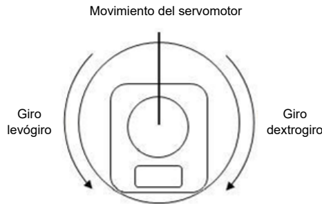
Figura 4.17: Dirección del movimiento en los servomotores visto frente al rotor, modificado de la página del fabricante 11
