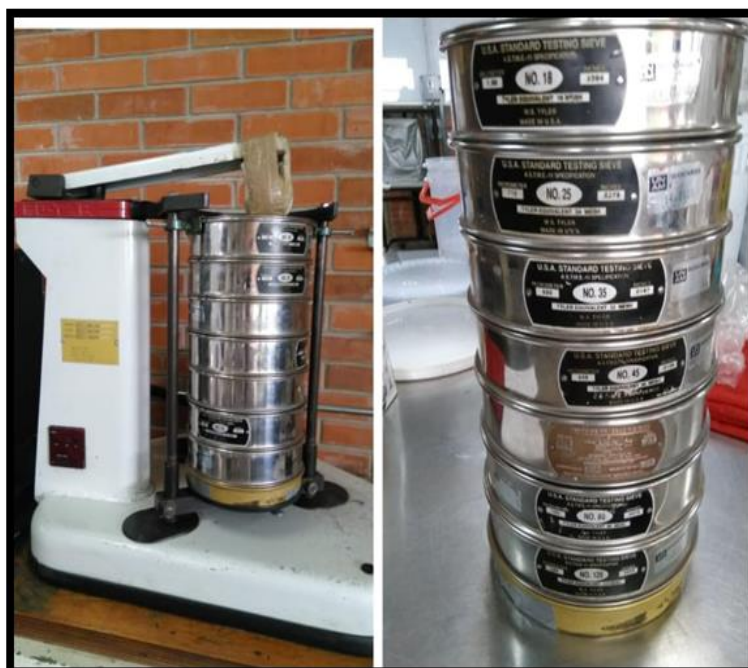
Figura 2. 7 Separación mecánica de las fracciones de tamaño de partícula en Rot- Tap; a) Tamices normalizados utilizados; b) Montaje de la serie de tamices en el equipo.
