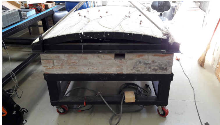
Figura 3: Fotografía del horno refractario creado para la termodformación de la membrana vítrea.
