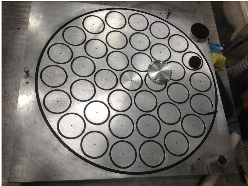
Figura 2: Fotografía de la celda con los círculos de los actuadores en bajo relieve. Se aprecia en los surcos el sello hidráulico u o-ring.
