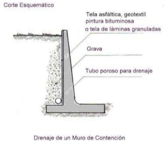
Figura 68 – Drenaje de un muro de contención.
