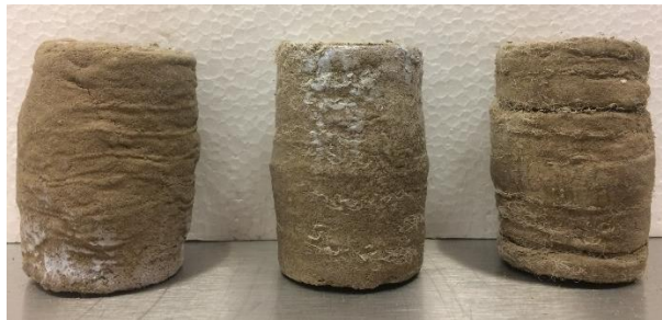
Figura 5.6 Probetas de suelo después de ser ensayadas (de izq. A derecha: Muestra con 0.1 % de fibra, Muestra con 0.5 % de fibra y Muestra con 0.7 % de fibra)
