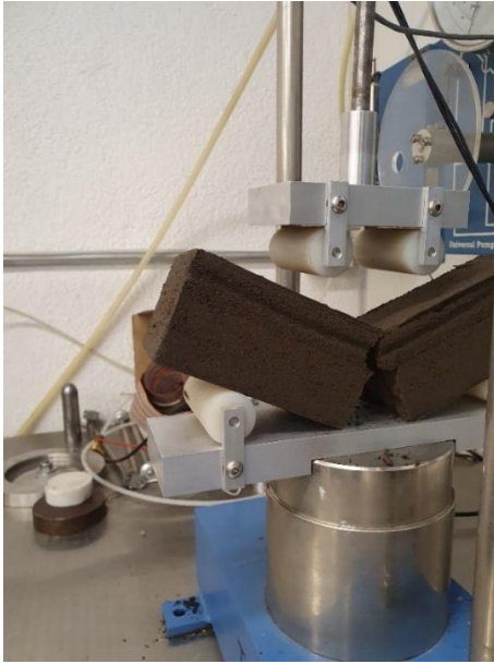
a) Inicio de agrietamiento viga sin fibra
