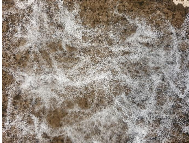
Figura 4. 20 Dosificación de fibra para una viga de suelo con 0.1% de fibra
