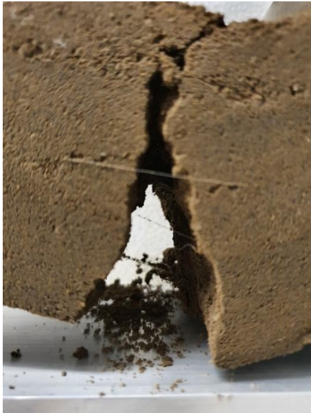
a) Falla presentada en la viga con 0.1% de fibra
