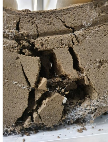
b) Falla presentada en la viga con 0.3% de fibra
