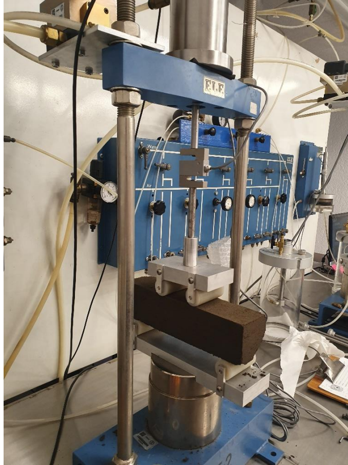
Figura 4. 21 Cámara triaxial para ensayos de viga a flexión
