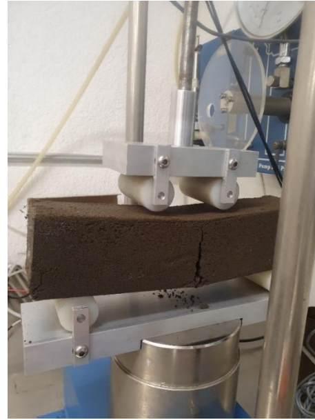
b) Inicio de agrietamiento viga con 0.1% de fibra
