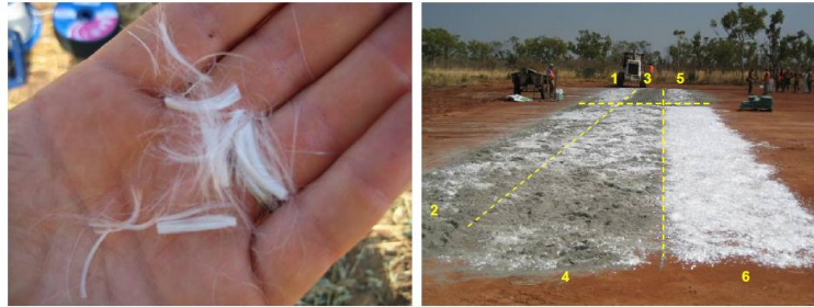
Figura 2. 17 De izquierda a derecha, fibras de polipropileno monofilamento y distribución de fibras en las secciones de prueba (Newman y White, 2008)
