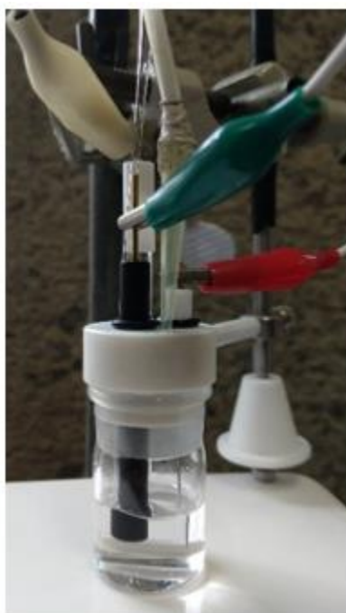
Figura 19. Celda de tres electrodos utilizada en los estudios de voltamperometría cíclica.
