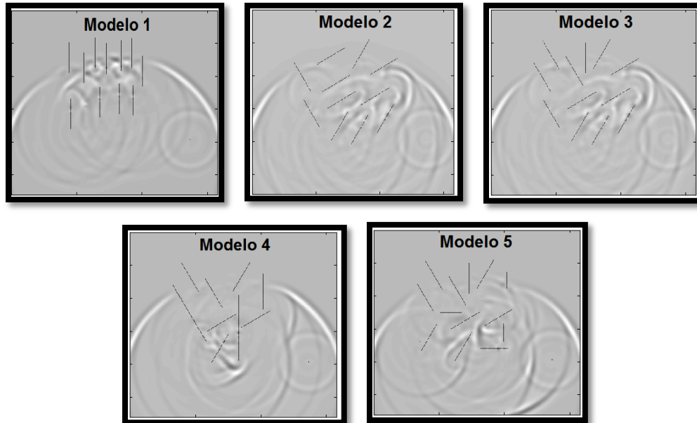
Figure 4.1.15. Instantánea del campo de ondas acústico propagándose sobre modelos conformados por fracturas con diferentes orientaciones.
