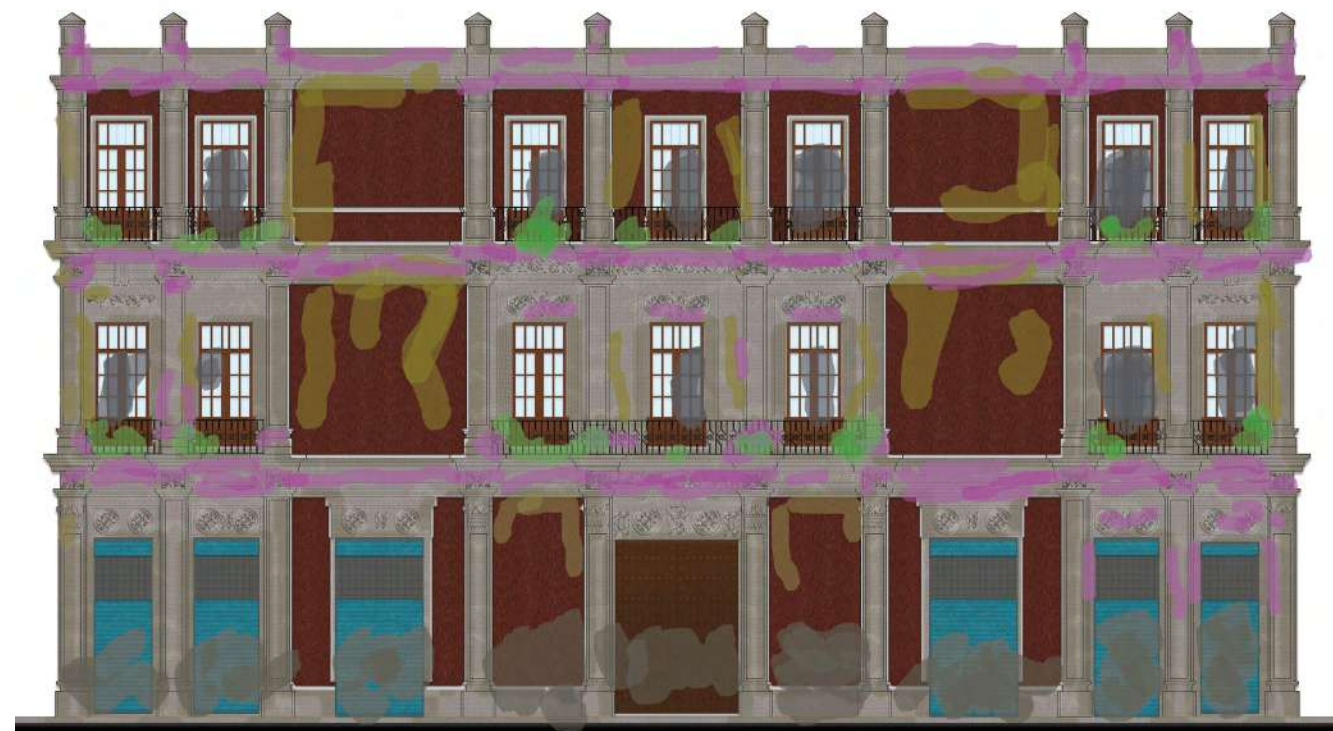
Palacios E. (2021) Fachada Actual y sus deterioros. Fig. [1]
