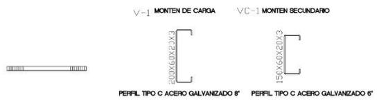
PERFIL TIPO C ACERO GALVANIZADO 6" PERFIL TIPO C ACERO GALVANIZADO 6"
