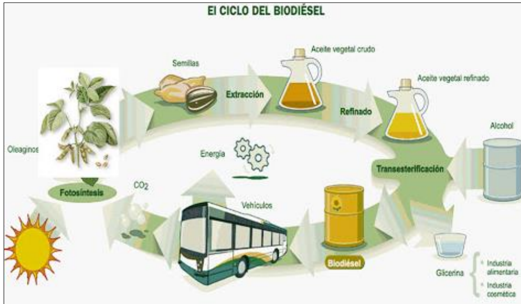
Ilustración 16. Ciclo del biodiésel
