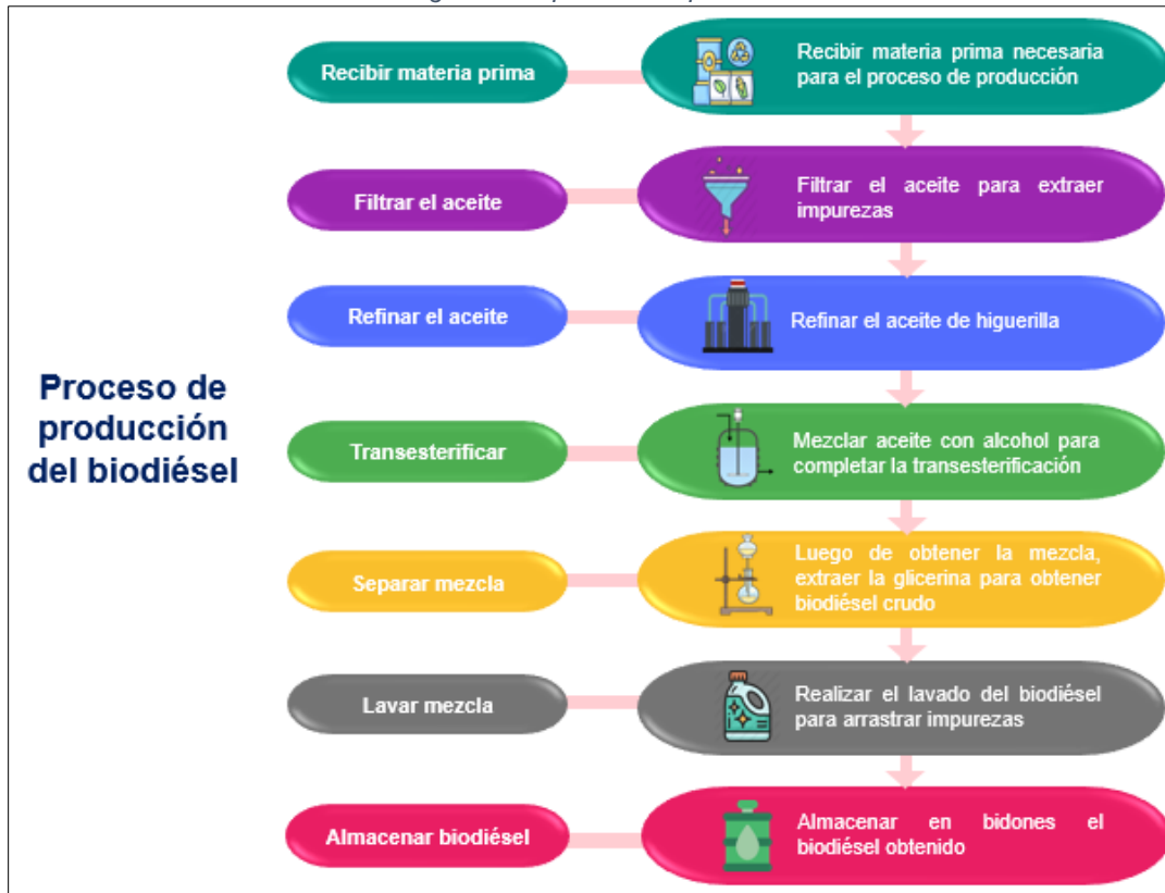
Ilustración 17. Diagrama del proceso de producción de biodiésel
