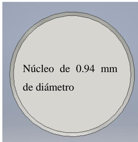
Figura 21. Vista frontal de la fibra de centelleo y su revestimiento de PMMA.
