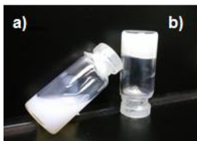
Figura 17. Fotografía que ejemplifica la prueba de inversión de tubo, al mostrar lo observado con el gel placebo con la proporción PF127:PF68 8:2. a) Gel placebo a una temperatura de 27 °C (líquida), b) Gel placebo a 37 °C (formación del gel en la parte inferior del tubo invertido).
