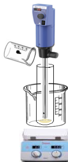
Figura 8. Preparación de NLC por homogenización a alto cizallamiento.
