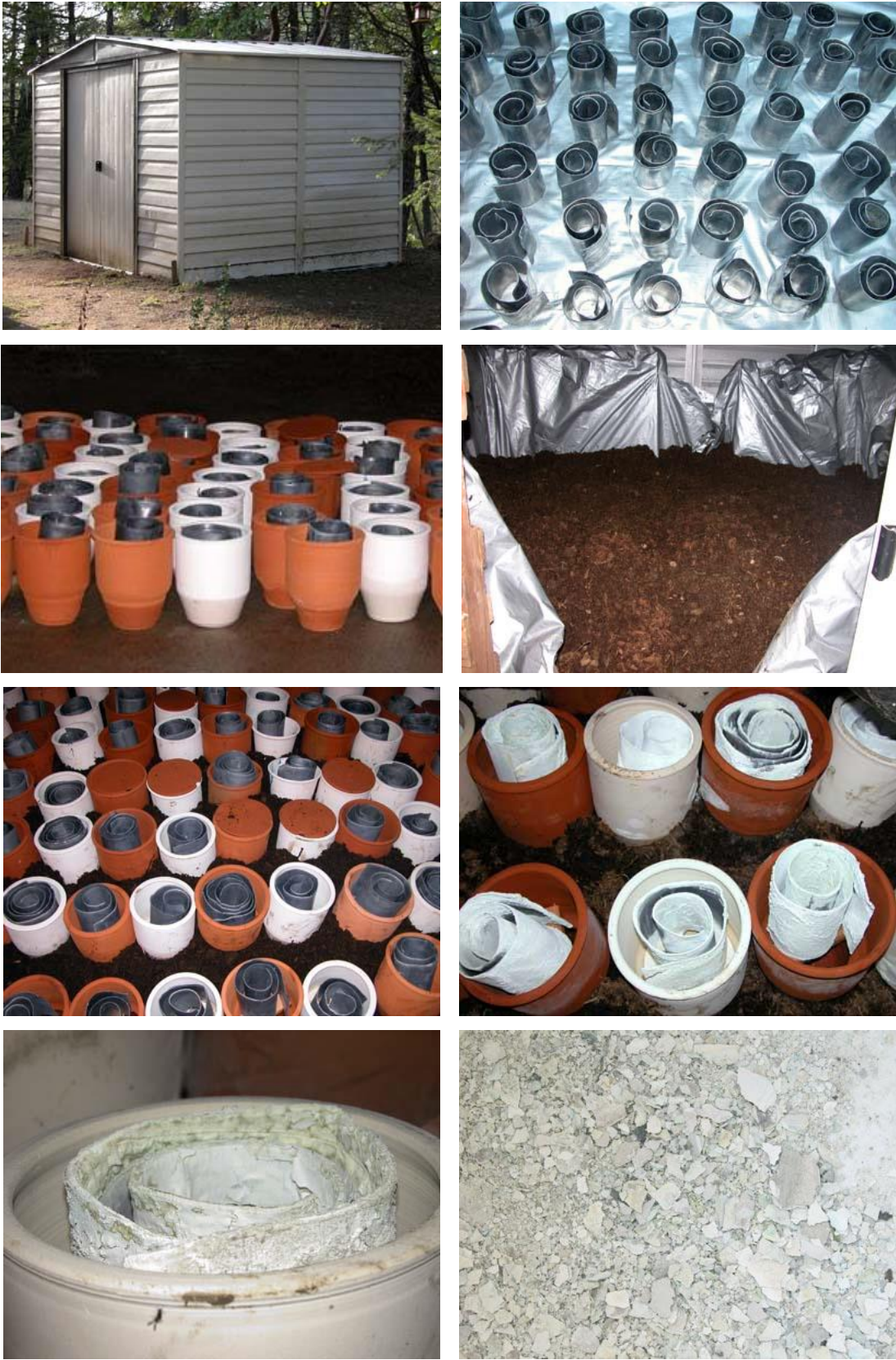
Figura 6. Reproducción del proceso de síntesis del blanco de plomo a la holandesa. 27,33
