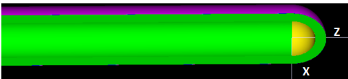
Figura 3.3 Corte longitudinal de los últimos 1.6 cm de la sonda del generador de rayos X INTRABEAM, donde se logra ver el blanco de conversión de oro (en amarillo) y la pared gruesa de Berilio (verde) y la última capa de Nitruro de Titanio (en rosa) que recubre la sonda del generador de rayos X, obtenida directamente de la aplicación egs_view .
