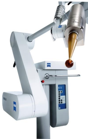
Figura 1.2. Sistema de radioterapia intraoperatoria INTRABEAM, compuesto por un brazo móvil, un generador de rayos X y un aplicador esférico.
