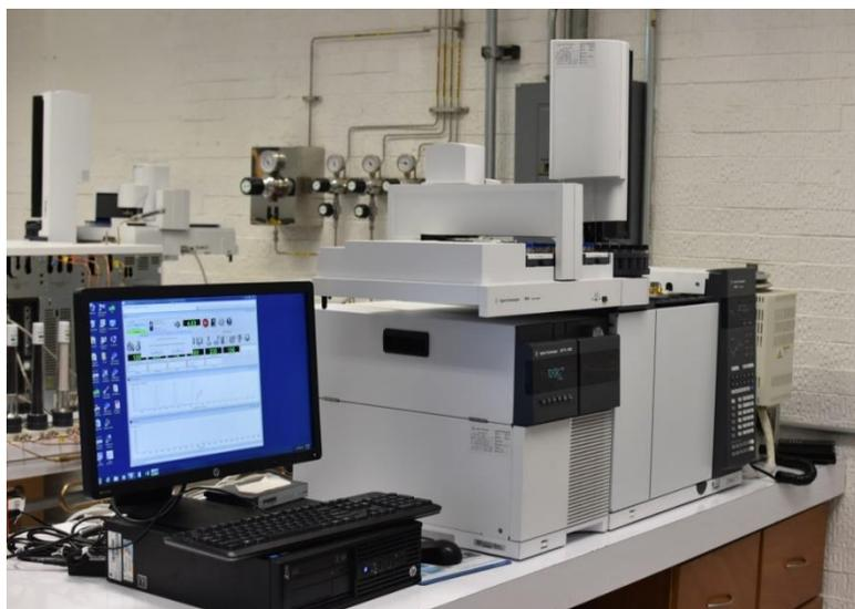
**Fig. 7. Cromatógrafo de gases acoplado a un espectrómetro de masas Agilent Technologies 7890 B-5977 A.**
