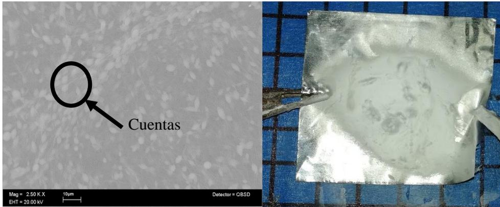
Fig. 17 Defectos del proceso de electrohilado.
