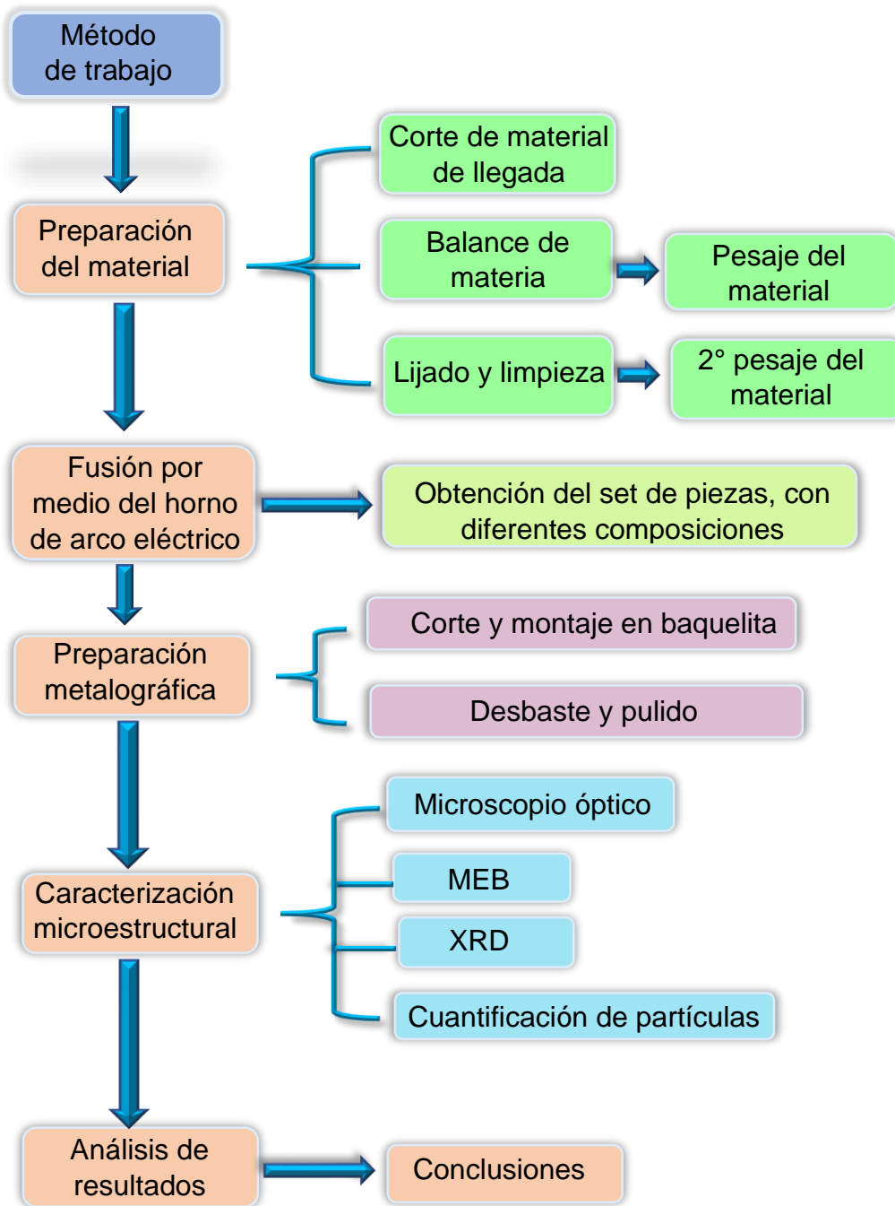
Figura 16. Diagrama de flujo de la síntesis y caracterización de aleaciones Fe-TiB 2 con diferentes adiciones de Y.
