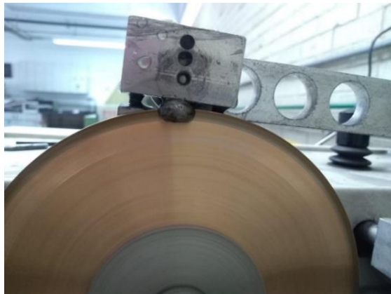
Figura 18. Corte de una probeta con disco de nitruro de boro.
