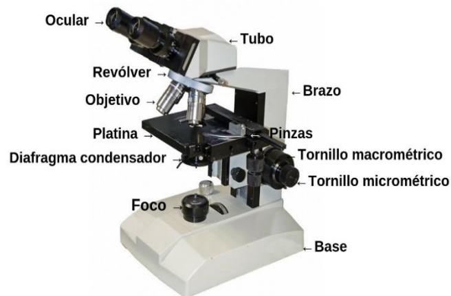
Figura 12. Representación esquemática de las partes del microscopio óptico [21].
