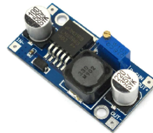
Figura 4.30: a) Diagrama eléctrico del convertidor Buck con el LM2596 b) PCB del convertidor
